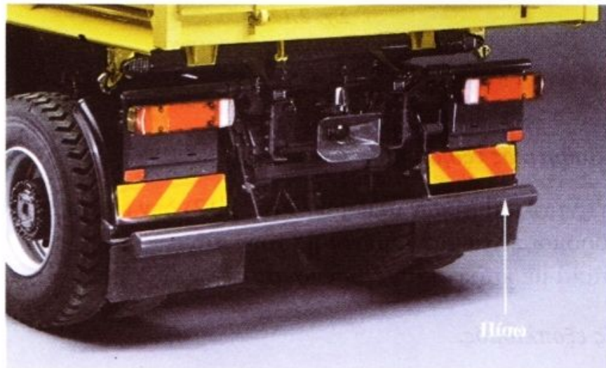
Σχ. 2.14 Προστατευτική διάταξη στο πίσω μέρος.
